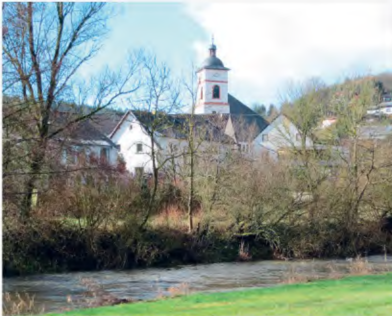
Der Standort der „Eisenschmitten und hutten“ (unter der Kirche, an der Kyll). Ein gut gewählter Platz, an der wasserreichen Kyll als Energielieferant für den Antrieb der Wasserräder, in waldreichem Gebiet zur Versorgung mit Holzkohle auf kurzen Wegen, zudem nicht allzu weit entfernt von den Erzgruben gelegen.
